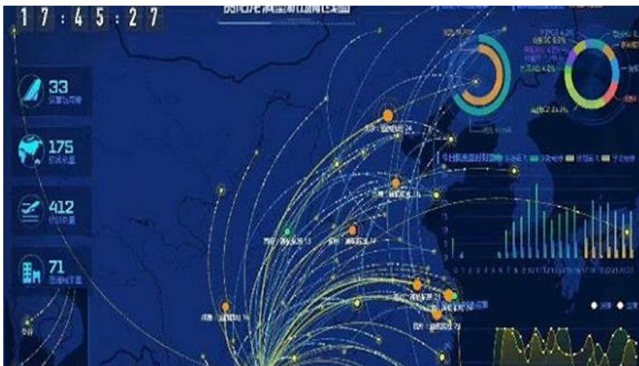
贵州省机场集团信息工程公司技术开发部经理安航举例称，当一个航班降落，A-CDM能识别出该航班的机型，并自动判断这个航班是近机位或远机位，从而判断其到达廊桥的耗时。通过大量的学习建模及情景分析，系统最终可得出一个精准预测时间，并把这个时间作为倒推，成为机场保障流程的标准依据。
