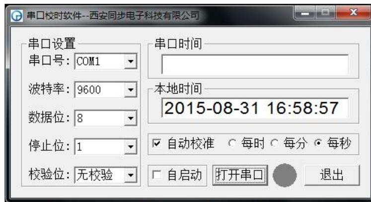
b) 在串口设置中选择 CPCI 板卡所连接的串口，假设连接的是串口 5，就选择串口号：COM5。CPCI 板卡使用的 115200bps 通信，所以波特率选择 115200。数据位，停止位，校验位默认设置。点击打开串口。串口显示的时间就是 PCIE 输出的时间。自动校准项勾选，后面选择每秒，串口校时软件就会每秒校准电脑一次，选择每分，代表每整分钟时校准，选择每小时，代表整时刻校准电脑时间。
