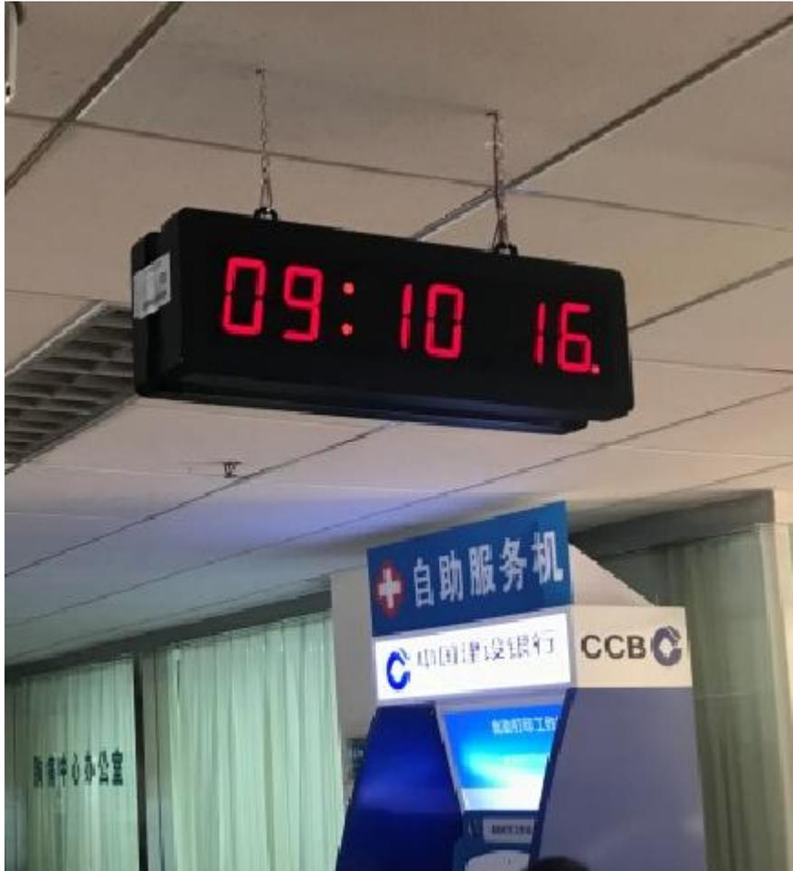
CDMA 授时版的网络电子时钟是通过当地电信基站接收 gps 卫星信号获取时间信息，只要天翼手机能接收信号的地方，均可以使用。但是这类电子时钟最大的缺点就是受制于运营商的政策，随着技术不断更新换代，4G 技术的成熟，有消息称 2G 信号随时都有被取代关闭的可能。一旦被关闭，CDMA 授时版的子钟将无法正常使用。当然即使可以用也会受到当地电信基站信号影响。但是 CDMA 的子钟使用方便，非常适合应用的场所是那些不方便架设天线，布线的单位，只需要供电即可正常使用。
