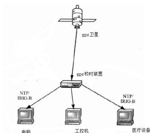
GPS 校时装置分为三个部分：GPS 天线、GPS 校时器和与 GPS 校时器连接的授时设备，其相应的功能和应用如下：
