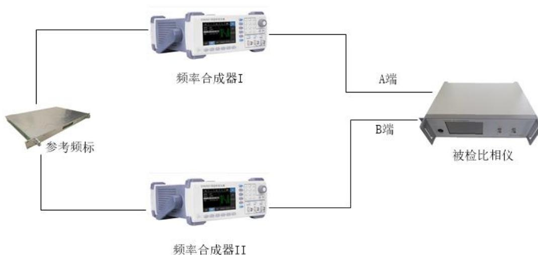
如图所示，测试比相仪输入 A 端频率点的输入灵敏度，将参考频标输出信号接至频率合成器 I 和 II 的外频标输入端，调节频率合成器 I、II 输出频率至比相仪上限频率，如 10MHz；频率合成器 II 的输出电压调至远大于被检比相仪最小输入电压指标值，频率合成器 I 的输出电压调至远小于被检比相仪最小输入电压指示值，然后增加频率合成器 I 的输出信号幅度，直至比相仪正常工作，记录此时的频率合成器 I 输出频率值及输出幅度值，即为比相仪输入 A 端该频率点的输入灵敏度。
