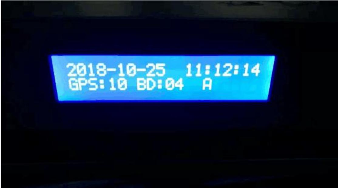
北斗校时装置设计分硬件和软件两大部分，硬件设计包括电源模块、接口模块、北斗天线、接收模块、复位电路 5 个部分；软件设计主要是读取 NMEA0183 格式的串口数据，解析出通信语句 GPRMC、BDGGA 等其中包含的经纬度、时间、海拔等数据，得到 UTC 时间再将其加 8 转换为北京时间，赋予给计算机系统，完成授时。校时系统硬件设计是以芯片为核心搭建外围电路，包括电源模块、电平转换模块、天线接口和复位电路。
