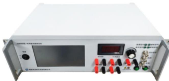
作为时间间隔发生器，其在设计上使用 7 寸大液晶触摸屏，采用大规模集成电路 FPGA 技术，全数字控制，实现高精度脉冲发生测试。
