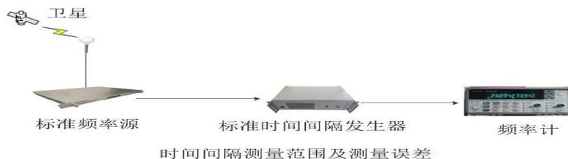
数字式频率计能直接测量在规定的时间内被测信号的脉冲个数，然后在显示屏上以数字形式显示出被测量频率值。这种方法测量精确度高、快速，适合不同频率、不同精确度测频的需要。数字式计数器测频有两种方式：一是直接测量法，即在规定的闸门时间内测量被测信号的脉冲个数；二是间接测量法，如周期测频法。
