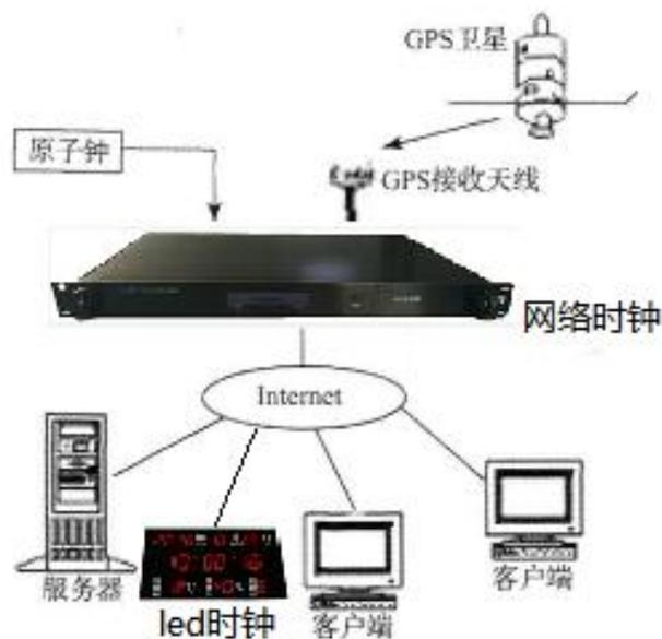
ieee1588 是一种精确时间同步协议,也称之为 PTP。PTP 同步时钟是拥有纳秒级别的传输精度,ptp 必须有硬件电路支持才可以使用,也就是必须有主从搭配方能使用。PTP 更为简单因此占用的网络和计算机的资源也更少,是针对更稳定和更安全的网络环境设计的。
