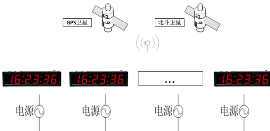
GPS 北斗双模授时类型标准时钟系统，和单独 GPS 授时类型，单独北斗授时类型的电子时钟系统类似，其主要是在 2018 年之前我国北斗卫星导航在技术上海相对欠缺的时期，在金融，广电，部队等机构，以北斗卫星为主，GPS 卫星为辅，保证电子时钟设备在全值工作状态下，时刻保持月卫星时间进行通讯，接收准确的卫星时间信息，再将这些时间信息准确无误的显示出来。
