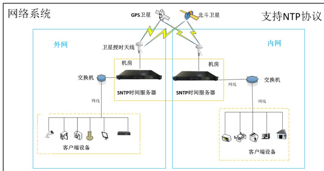
如图，SNTP 服务器服务于整个网络系统，同时接收来自 GPS 北斗卫星的标准时间信息，通过解析处理以局域网的形式，通过 SNTP 协议给外网和内网的客户端设备提供标准的时间统一功能。
