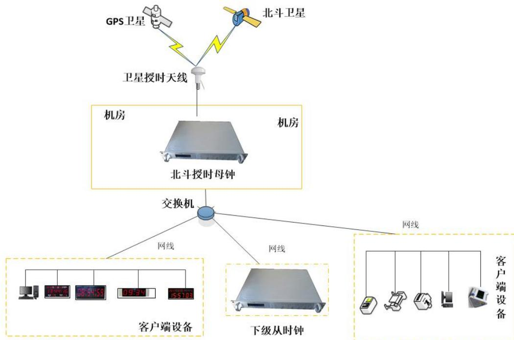
如图所示，北斗授时母钟接收北斗和 GPS 的卫星信号，设备参考可选择北斗，GPS，北斗 GPS 双模三种模式，默认选择接收北斗输入信号；北斗授时母钟以 NTP 网络输出信号为主，通过连接下属交换机设备，分别给客户端设备和下级从时钟设备进行授时。
