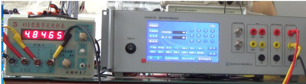
通常用继电器来模拟电秒表输入信号机械触点的闭合与断开，但因继电器不稳定且动作延迟为毫秒量级，无法满足检定时对标准设备的要求。因此检规中给出了用电脉冲信号电平的高低来代替机械触点的闭合与断开。而几乎所有的时间间隔发生器都可以产生电脉冲号。
