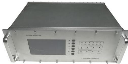
这款产品是 SYN4505A 型时钟同步系统,它里边装有高精度的恒温晶振,可以接收来自 GPS 卫星和北斗二代卫星传来的信号获取精准的时间,也可根据客户的不同需求来定制相对应的授时板卡,同时可以产生各种信息,系统会对这些信息进行自动保存,实现标准时钟的时间同步装置。该设备
