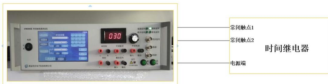
如图所示，在实际操作过程中时间继电器的测试仪连接启动端连接时间继电器的电源端，时间继电器的常闭触点 1 和 2 对应时间继电器测试仪，通过这种方法进行通电延时型时间继电器整定误差的校准。
