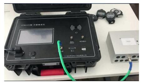
日差检定仪具有接触和非接触测量两种功能,配置台式传感器和手持式传感器方便用户在不同应用环境下使用,内置恒温晶振使用时需要预热 30 分钟后测试效果比较准确。
