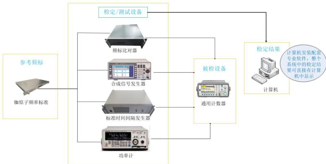
如图所示,整个通用计数器检定系统主要分为四个组成部分：参考频标，检定/测试设备，被检设备，检定结果；整个系统的设备组成由铷原子频率标准，频标比对器，合成信号发生器，标准时间间隔发生器，功率计，通用计数器，计算机及软件组成。
