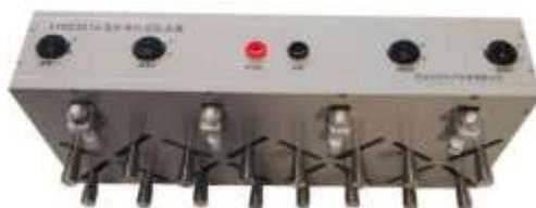
时间检定仪秒表区域配置有红色和黑色香蕉头线缆, 和时间检定仪秒表区域直连, 每一路设备都有独立的开关控制。夹具在设置中可垂直放置, 也可水平放置, 且不用做多余的支撑辅助, 可直接实现秒表在不同角度的检定。
