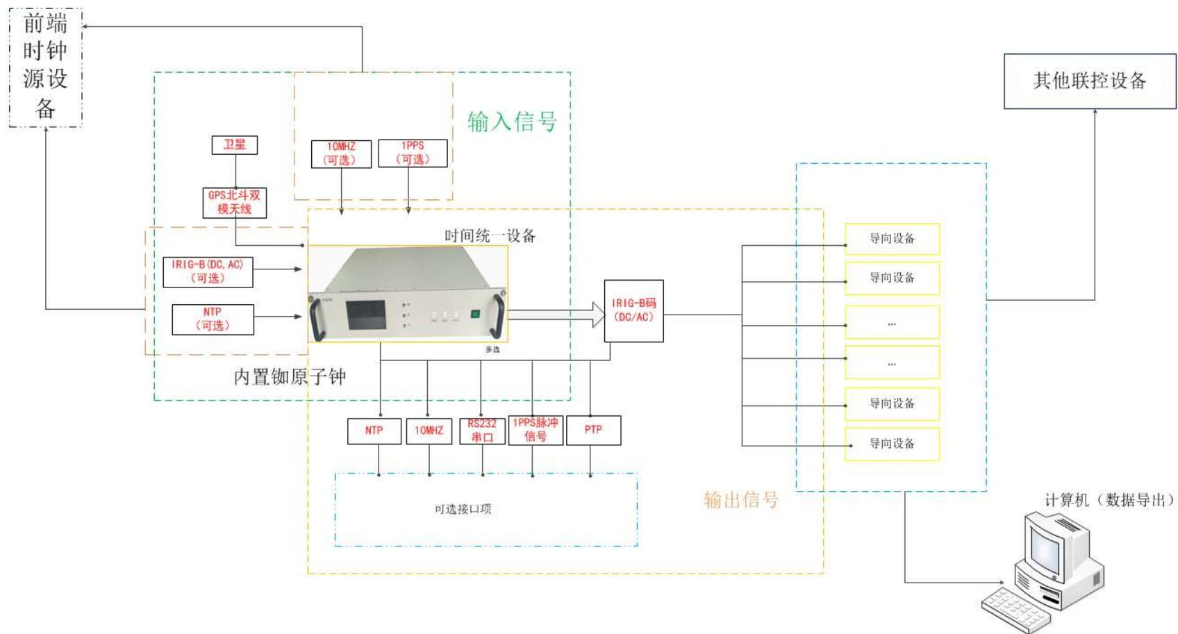
如图所示时统设备在整个系统运行中，主要由输入信号区域和输出信号区域组成。输入信号以接收 GPS 北斗信号为主，同时可选择接收 IRIG-B 码/NTP/PTP/10MHz/1PPS 等时间源信号参考源为辅，作为无手动时间源输入参考。输出信号以 IRIG-B 码授时协议为整个系统的主要授时方式，同时可产生 NTP/PTP/10MHz/1PPS/串口 232/485/422 等多种授时信号作为授时参考，其具体选择根据项目中实质可用到的授时方式进行选择。
