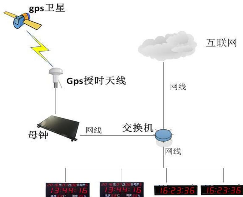
母钟（NTP 网络时间服务器）接收来自卫星的时间信号，通过网络方式走 NTP 协议通道将标准时间信号直接传给各个显示子钟，为工
