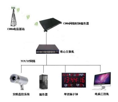
每台 CDMA 网络时钟服务器里面都装有一块 CDMA 接收机,用来接收 CDMA 时钟信号,通过 cpu 读取 cdma 时钟里面的时钟信息,精度在亚毫秒量级,通过其他有效时钟编码方式进行输出,一般采用串口 tod, 1pps, NTP、SNTP等方式进行输出,客户端通过这些授时方式进行接收,就可以实现精确授时,这样就完成了整个 CDMA 授时的过程。
