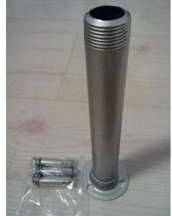
本机天线为“蘑菇”型天线，为保证天线安装牢固和可靠，在天线安装时，可选择一根铸铁水管（长度可考虑1~1.5米），将天线置于铸铁管的一端，铸铁管的另一端电焊在加重的金属底座上，然后安置于房顶即可。
